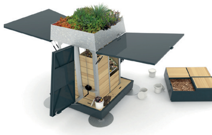
↓ (fig. 25) Comprendre la structure d'un EKOVORE nouvelle génération. Modélisation 3D du composteur, © FALTAZI, D.R.
